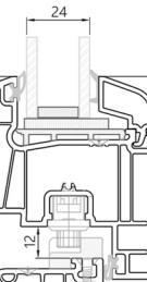
СТУЛКА ДВЕРНА 115мм + ИМПОСТ 84мм + СТАТИЧНИЙ З'ЄДНУВАЧ
